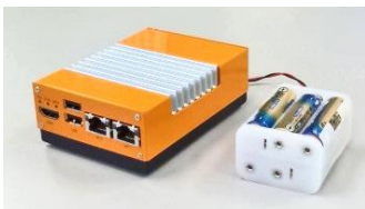
実験室でアルカリ乾電池で動作させている様子。単3電池6本で30分以上稼働します。
