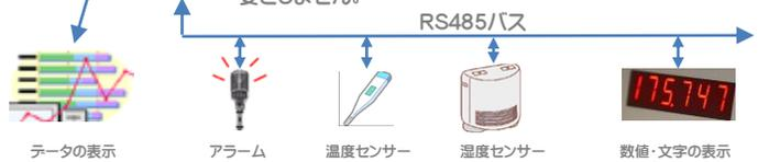
RS485 I/Fを使用するEasy-IoT™キットを準備しています。様々なセンサー情報を容易に収集し、クラウドなどへのアップロードが、容易に実現できます。
