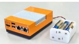
実験室でアルカリ乾電池で動作させている様子。単3電池6本で30分以上稼働します。
